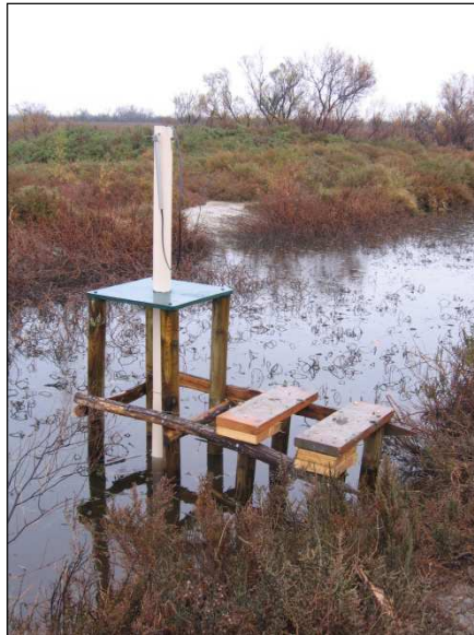
Sonde CTD installée sur le chenal d'amenée d'eau du canal du Japon à l'aval de l'ouvrage de contrôle de l'entrée d'eau sur le site (photo : O. Boutron / Tour du Valat ).
